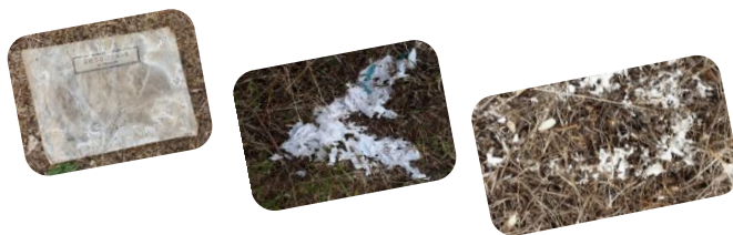
Photo d'un test réalisé en 2019 : décomposition naturelle de la pochette après 6 semaines à l'air.
